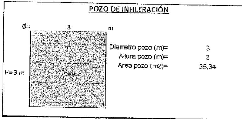
Figura 1. Pozo de infiltración
